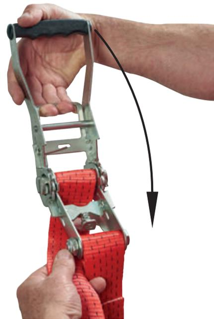
2. Zum Lösen den Funktionsschieber ziehen und Ratschenhebel um ca. 180 Grad umklappen.
