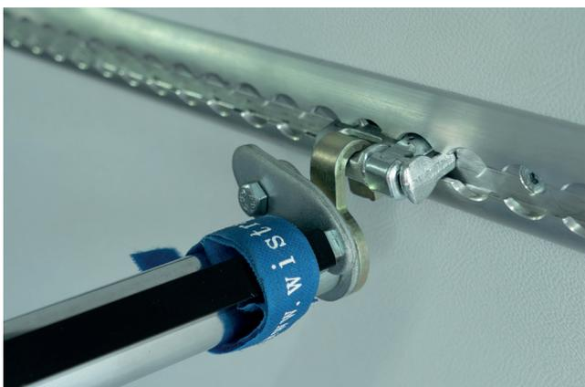
Einhängen der Kleiderstange in den Double-Airline-Fitting
