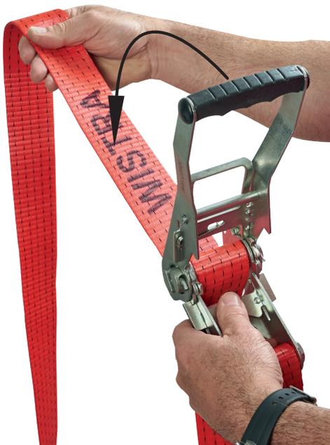
1. Nach Ziehen des Funktionsschiebers den Ratschenhebel hochschwenken und dann den Gurt einfädeln.
